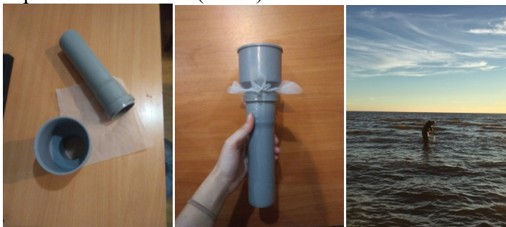
Рис.2 Самодельная фильтровальная установка для отбора проб микропластика в водоемах и процесс пробоотбора.
